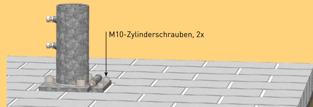
2. Lösen Sie die M16 - Schrauben an der Ankerhülsenplatte.
