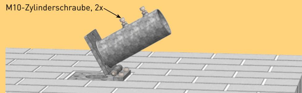
5. Stecken Sie ein dünnes Hart-Kartonstück (280 x 230 mm, max. 2 mm Dicke) in das Ankerhülsen-Oberteil. Das schützt die Pulverbeschichtung am Hauptmast beim Einfahren des Schirmes vor Kratzerbildung.
