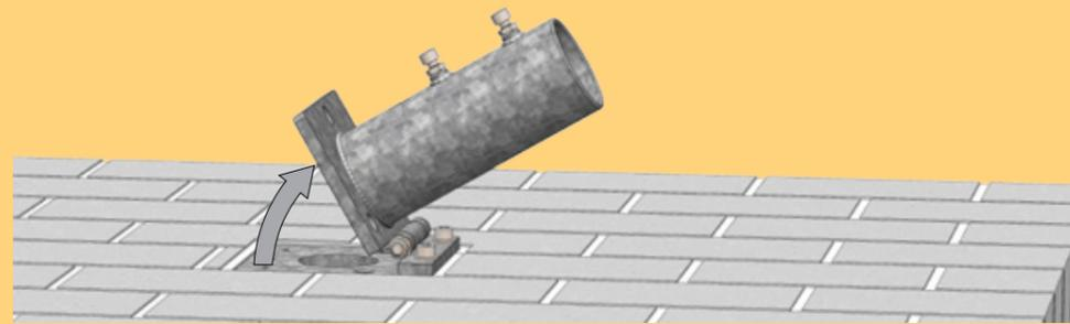
4. Lösen Sie die zwei M10- Zylinderschrauben im Ankerhülsen-Oberteil so weit, dass im Inneren des Rohres keine Schraube übersteht, damit Sie den Schirmmast später horizontal einfahren können.
