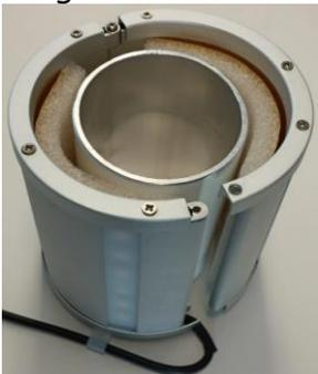
6. Den LED-Ring schließen und mit der Schraube und den Torx-Schlüssel sichern.
