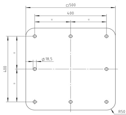
Bohrungen für Schwerlastanker nicht ohne Grundplatte an Baustelle bohren. Es sind insgesamt 8 Schwerlastanker notwendig. Erhältlich unter der Artikelnummer 200900, in Edelstahl A4, 2 Packungen notwendig.
