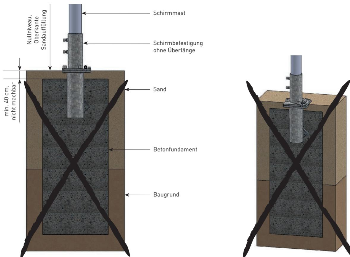
Diese Ausführung ist nicht normkonform und darf folglich nicht eingesetzt werden.
