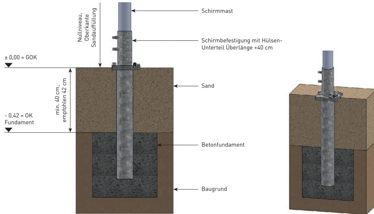
**Vorteil:** Der Schirm kann fachgerecht auf- und abgebaut werden. Das Klappscharnier hat seine volle Funktion, es muss kein Sand bei der Montage abgetragen werden.
