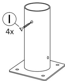
Das Standrohr (A) mit geeigneten Befestigungselementen (nicht im Lieferumfang enthalten) auf einem ebenen Betonboden fest verschrauben.
