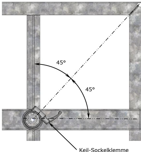
4. Fixieren Sie die Zylinderkopfschraube mit dem 6-er Inbusschlüssel.
