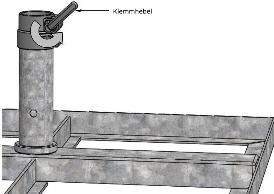
2. Lösen Sie mit einem 6-er Inbusschlüssel die M8-Zylinderkopfschraube. Drehen Sie die Schrauben gegen den Uhrzeigersinn auf, zwei Umdrehungen sind ausreichend.
