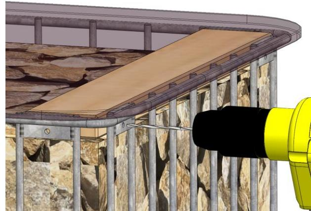
11. Fixieren Sie die Sitzplatte mit den vier mitgelieferten Schrauben mit einem Torx 20. Für jede Ecke ist eine Schraube vorgesehen.
