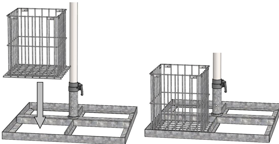
7. Besorgen Sie sich Steine Ihrer Wahl. Die Steinkörnung muss größer oder gleich 60/90 mm oder mindestens größer als die Maschenbreite 50 mm sein. Bei einer 60/90 mm - Steinkörnung kommt eine Füllung (Lichte Weite 335 x 335 mm, 390 mm Höhe) auf ca. 66 kg Ballast. Beim Bedarf richten Sie sich nach folgender Tabelle:
