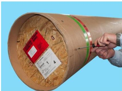
Mit einem Kreuzkopfschraubendreher entfernen Sie als erstes alle 10 Schrauben und Unterlegscheiben vollständig aus der Zylinderwandung.
