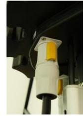
**ACHTUNG:** Gehen Sie sicher, dass die Stecker vollständig eingerastet sind, bevor Sie den Strom anschalten und ziehen Sie die Stecker nicht heraus, wenn die Stromversorgung eingeschaltet ist. Andernfalls können die Steckverbindungen verschmoren und somit zerstört werden.
