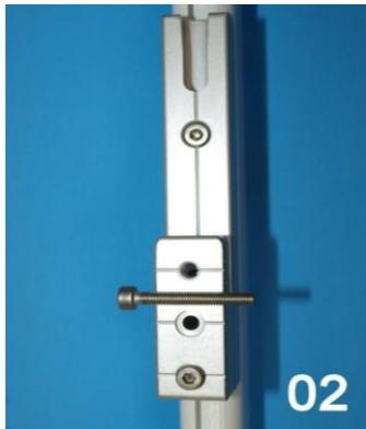
Setzen Sie das Deckprofil aus Bild 01 auf das bereits fest im Gelenkstützenprofil montierte „Klemmteil“ auf und montieren es mittels der beiden Montageschrauben.
