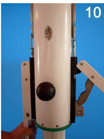
**10** **Rechten** Spannhebel erneut öffnen: dabei schiebt sich der Federbügel von selbst nach oben und klinkt sich von selbst oder durch leichtes Andrücken in die obere Raste der Zugstange ein.
