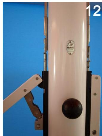
**12** **Linker** Spannhebel ist in die obere Raste der Zugstange eingeklinkt.
