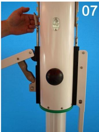
**07** **Linken** Spannhebel öffnen, mit der anderen Hand den Federbügel zurückziehen, um ihn bei weiterem Öffnen des Spannhebels in die untere Raste der Zugstange einklinken zu können.
