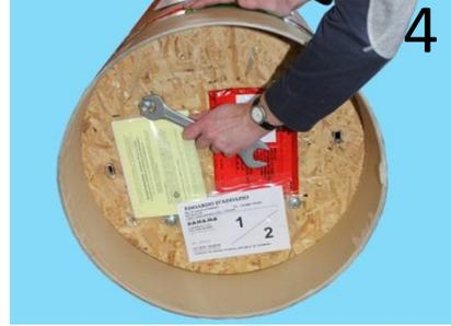
**4** ... schrauben Sie mit dem 24er Gabelschlüssel (aus dem Beipack) die außen liegenden Muttern von ihren vier Transportschrauben ab, die nur dazu da sind, die Aufbau-Konsole und damit den Schirm im Transportzylinder zentriert zu halten.
