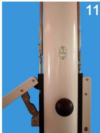
**11** **Linken** Spannhebel erneut öffnen: dabei schiebt sich der Federbügel von selbst nach oben und klinkt sich von selbst oder durch leichtes Andrücken in die obere Raste der Zugstange ein.
