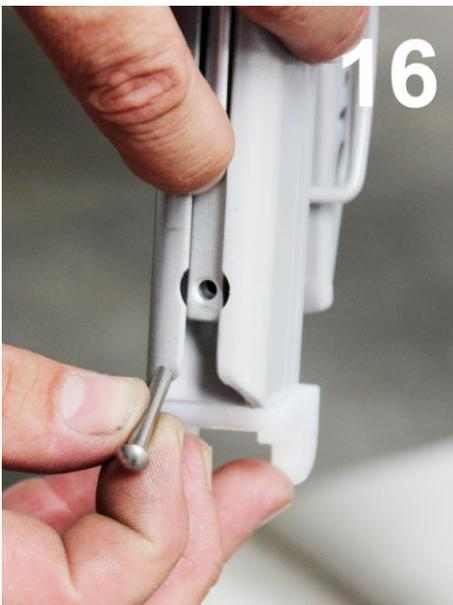
Nehmen Sie einen schlanken Schlitz-Schraubendreher, um den Sperrstift – hier im Bild bereits entfernt – anzuheben und herauszunehmen. Dieser Stift sichert die Schiene [den "Membranhalter"] auf der Oberseite jeder Diagonal-Dachspeiche bzw. jeder Rundspeiche und .....
