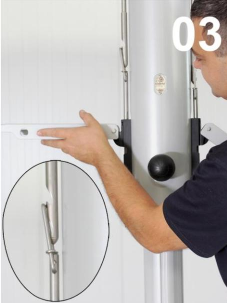
**03** Beide Spannhebel öffnen – den **rechten** nur in etwa so weit, wie im Bild gezeigt – und den Federbügel des **linken** Spannhebels aus der oberen Raste der Zugstange ausklinken .....
