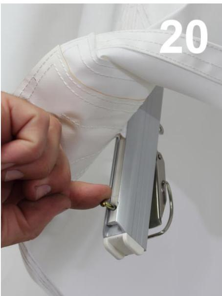
Nehmen Sie wie in Bild 16 gezeigt einen schlanken Schlitz-Schraubendreher, um den Sperrstift – hier im Bild bereits zur Hälfte herausgezogen – anzuheben und herauszunehmen.
