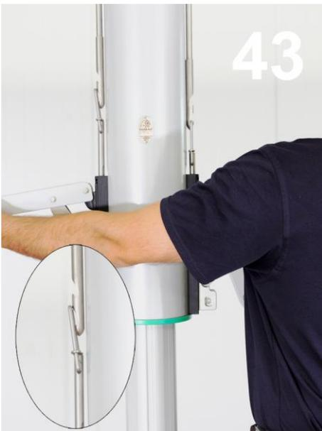
Öffnen Sie dann den **linken** Spannhebel weit genug, um auch hier den Federbügel in die untere Raste der Zugstange einklinken zu können.
