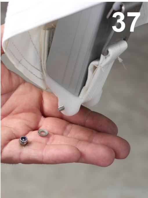
..... setzen die Unterlegscheibe und Mutter [aus Bild 14] auf .....
