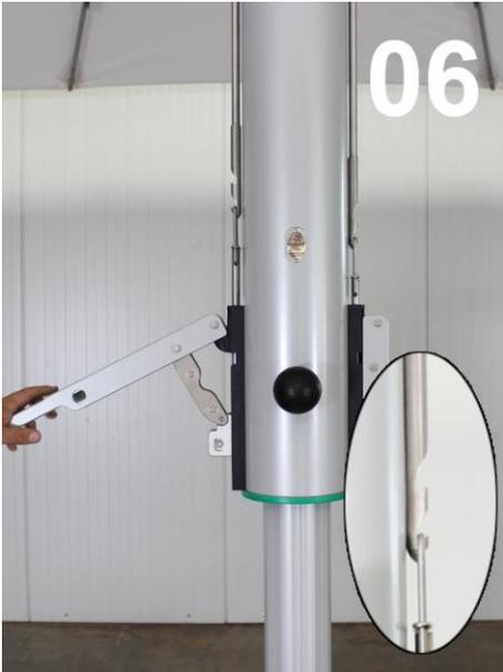
Den Federbügel des **rechten** Spannhebels in der unteren Raste der Zugstange Einklinken und Spannhebel komplett umlegen.
