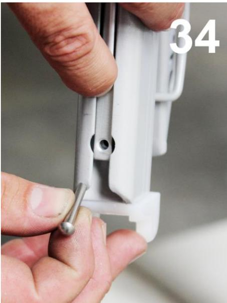
Setzen Sie den Sperrstift [aus Bild 16] wieder ein, um sicherzustellen, dass die Schiene in ihrer Endposition arretiert bleibt.
