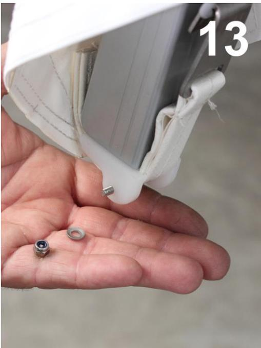
Entfernen Sie die selbstsichernde Mutter mit U-Scheibe und .....
