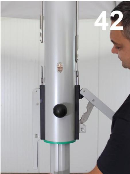
Öffnen Sie den **rechten** Spannhebel und schieben Sie den Läufer so weit nach oben, dass Sie den Federbügel in die untere Raste der Zugstange einklinken können.
