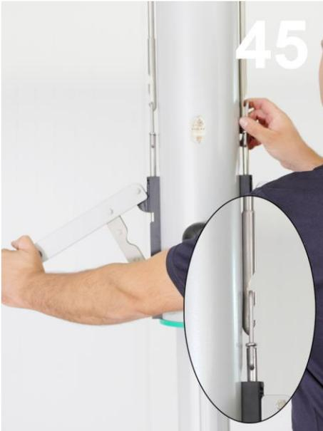
..... den Federbügel des **rechten** Spannhebels nun in die obere Raste der Zugstange einklinken zu können.
