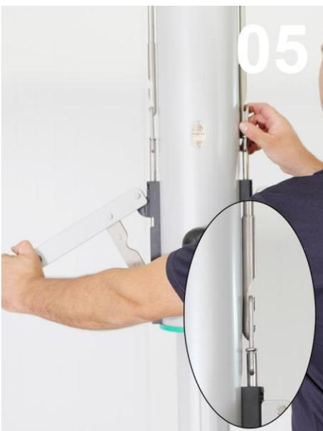
**05** ..... den **rechten** Spannhebel so weit öffnen, dass sich der Federbügel aus der oberen Raste der Zugstange ausklinken lässt.
