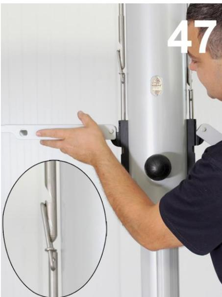
..... auch hier den Federbügel in die obere Raste der Zugstange einklinken zu können. Klappen Sie nun beide Spannhebelverschlüsse gleichzeitig nach unten um.
