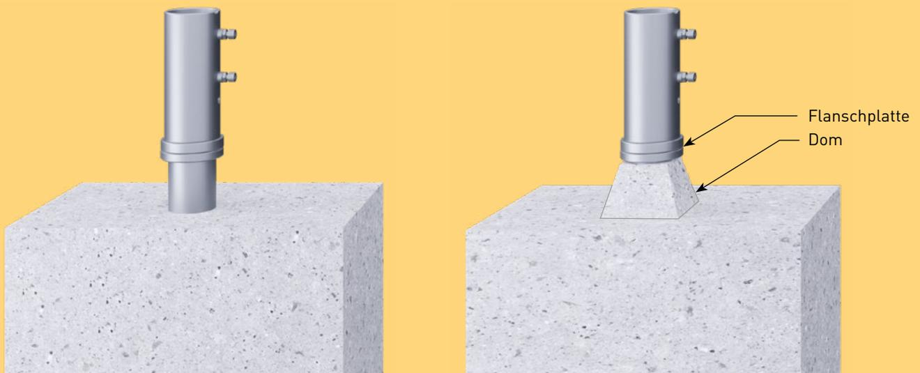
7. Damit die Winterabdeckung (bei Abnahme des Ankerhülsen-Oberteils) ebenerdig abschließt (vgl. Abbildung b), drücken Sie das Ankerhülsen-Unterteil 4 mm tiefer als die Terrassen-Oberfläche in den Beton ein (vgl. Abbildung a: für eine deutlichere Darstellung wurde das Oberteil in der Zeichnung ausgeblendet). Somit vermeiden Sie eine Stolperfalle.
