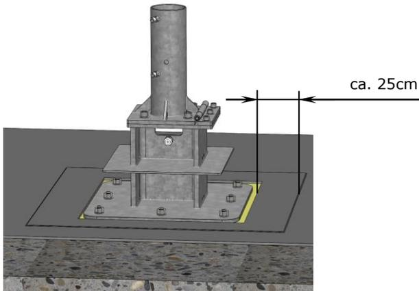
2. Verlegen Sie das Dämmmaterial der Wärmedämmschicht bis unterhalb der Klebeflanschplatte.
