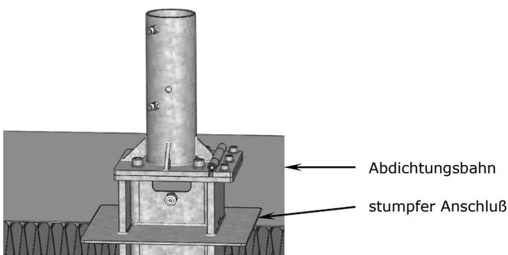
4. Die zu benetzende Fläche auf dem Klebeflansch muss gereinigt werden, bei Bedarf mit einem Reiniger. Diese Fläche muss zudem nach der Grundierungstabelle des Produktherstellers für Flüssigkunststoffe vorbehandelt werden. Erst dann kann das Vlies ordnungsgemäß verklebt werden. Die Flüssigkunststoff-Abdichtung dann mit einer Breite von über 10 cm rundum auf dem Klebeflansch auftragen.
