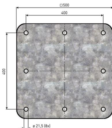
2. Verschrauben Sie die Ankerplatte auf die Stahlbeton-Decke. Bei Schwerlast-Ankerbolzen Ihrer Wahl befolgen Sie die Hinweise des Herstellers. Von der Firma MAY gelieferte Schwerlast-Ankerbolzen werden wie folgt angebracht.
