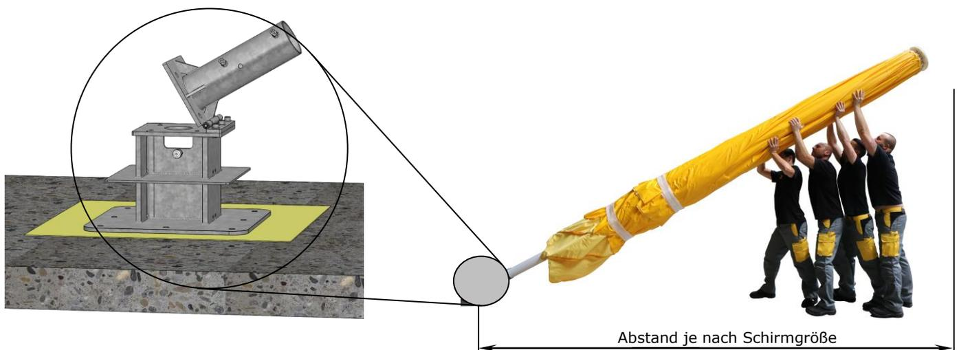
3. Positionieren Sie die AZ186 durch genaues ausmessen der Schirmachse. Halten Sie einen Sicherheitsabstand zwischen den Schirmen / Hauswand.
