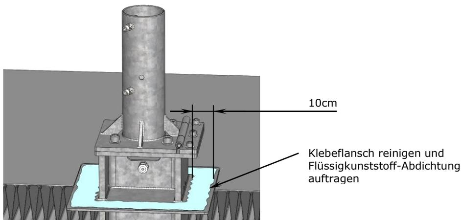
5. Die Flüssigkunststoff-Abdichtung dann mit einer Breite von über 10 cm Anschlussbreite rundum auf der Abdichtungsbahn auftragen. Folglich entsteht rundum eine Vliesabdichtung mit min. 20 cm Breite.
