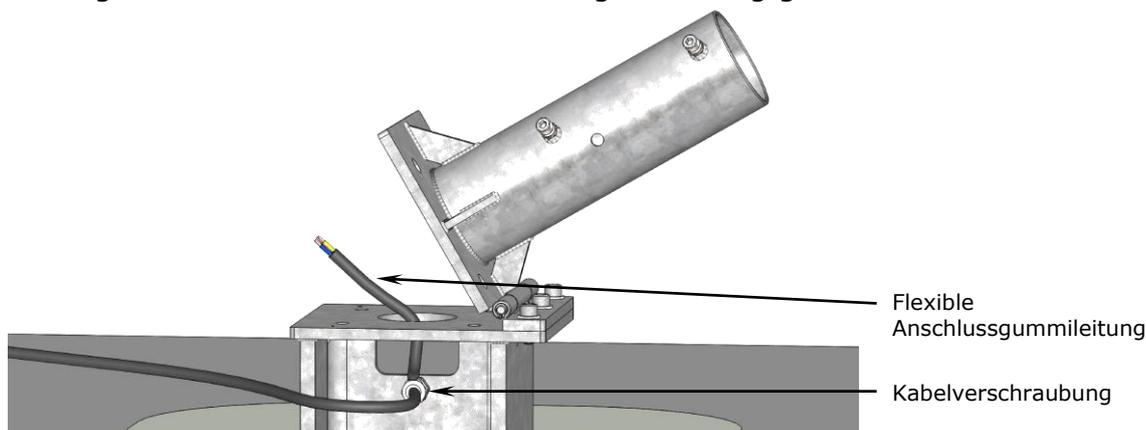
2. Verbinden Sie die Anschlussgummileitung und die Stromversorgung für den Sonnenschirm wasserdicht. Die Anschlussgummileitung (bei Starkstrom: min. 5-polig, min. 4mm<sup>2</sup> Leitungsquerschnitt) muss passend zu Verbrauchern und Zuleitungslänge von einem Elektrofachmann ausgelegt werden.
