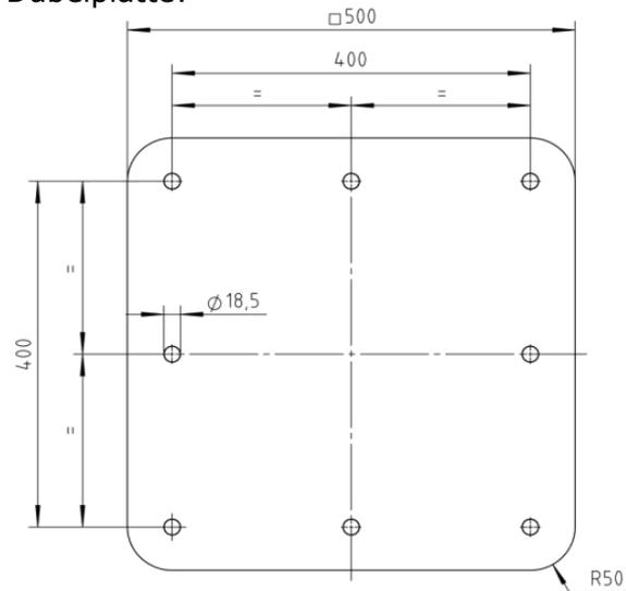
Bohrungen für Schwerlastanker nicht ohne Grundplatte an Baustelle bohren. Es sind insgesamt 8 Schwerlastanker notwendig. Erhältlich unter der Artikelnummer 200900, in Edelstahl A4, 2 Packungen notwendig.
