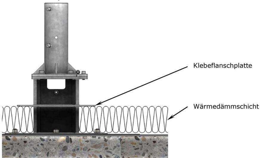
3. Die Abdichtungsbahn auf die Wärmedämmung auftragen. Dazu eine passende Aussparung in die Abdichtungsbahn schneiden, so dass diese stumpf am Klebeflansch anschließt. Abhängig vom Abdichtungstoff muss ggfls. eine weitere Trennlage angebracht werden.
