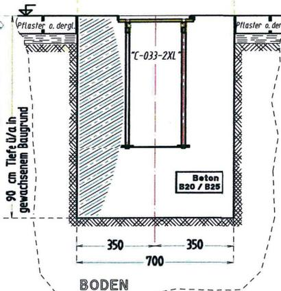
Fund.-Einbau-Konsole der "Universal-Bodengruppe" # C-033-2XL [KEINE elektr. Ausbaustufe] Einrichtung im Fund.-Körper ZENTRISCH (s.o./Zg.)!
