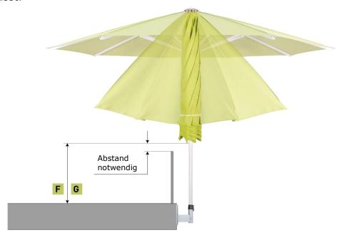
Rechnen Sie den Höhenversatz der DMZ125 ein. Wird die Dübelplatte bündig verankert, verringern sich die Maße F und G am Schirm um 26 cm. Sollte das Schirmdach mit dem Geländer kollidieren, kann eine Schirmmastverlängerung Abhilfe schaffen. Der Einsatz einer DMZ170 anstelle der DMZ125 ist ein weiterer Lösungsansatz.
