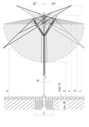
Loser Deckbelag max. 10 cm, Betondicke min. 30 cm (Frosttiefe beachten), Wasserabfluss gewährleisten.
