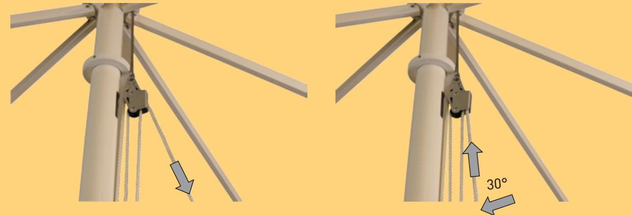
FILIUS mit Kurbel FK: Stecken Sie die Handkurbel in die Getriebebohrung und drehen Sie den Schirm, gegen den Uhrzeigersinn zu.
