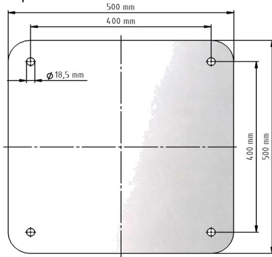
Beim Verbohren der Schwerlastanker die Grundplatte als Bohrschablone verwenden. Es sind insgesamt 4 Schwerlastanker notwendig. Erhältlich unter der Artikelnummer 200900, in Edelstahl A4.
