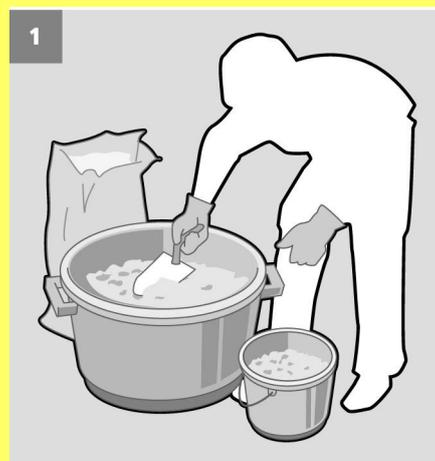
Das Verhältnis Zement/Sand/Kies für Beton ist 1:2:3. Mischen Sie also 1 Teil Zement, 2 Teile Sand und 3 Teile Kies. Ein Teil ist zum Beispiel eine Schaufel, ein Eimer oder ein Sack. Die benötigte Menge an sauberem Wasser ist nicht genau zu beziffern, weil diese von der jeweiligen Sorte Zement, Sand und Kies die Sie verwenden, abhängig ist. Im Durchschnitt ist die Anzahl an Liter Wasser auf 25 kg Betonmörtel 2,5 Liter. Der Mischung liefert dann circa 12 Liter Beton(speis).
