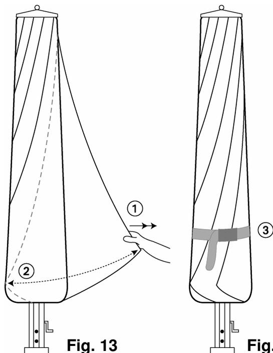
Vermeiden Sie Klemm- und Scheuerschäden und vorzeitige Abnutzung durch starkes flattern und schlagen des Stoffes im Wind
