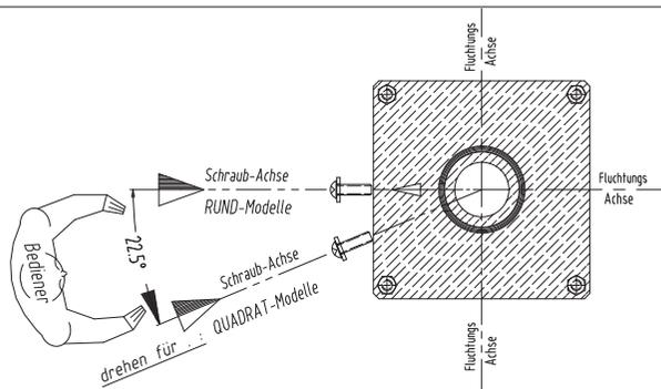
im Aufnahme-Rohr: Langloch = Schraub-Achse zeigt zur BEDIENER-Seite!
